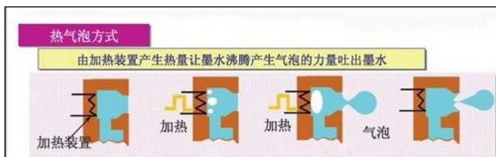
图 1 热发泡喷墨打印技术工作原理
