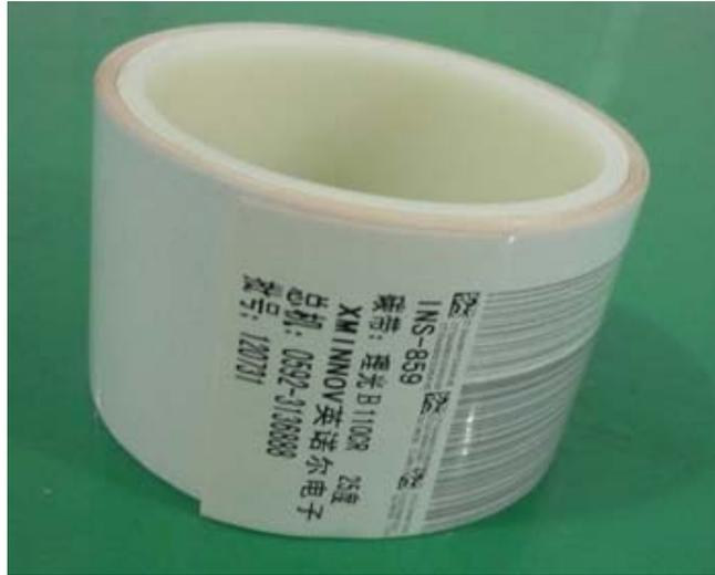
耐高温条码标识材料是公司自主研发一种新型膜材料。本系列产品主要是以聚酰亚胺薄膜（PI）为基材，涂布特种的树脂油墨及永久性的导电压敏胶，其产品特性为耐温大于或等于 315 度，表面电阻在  $10^4$  至  $10^9$  欧姆，表面既可以适合印刷又可以热转印、耐酸碱、耐化学擦拭，广泛应用于 PCB-SMT、芯片、精密器件的制造过程标签的追溯，尤其适用于电脑主板、手机摄像模组、电源适配器等 EMS 现场信息化管理。
