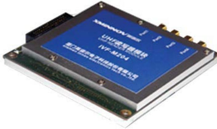
超高频 RFID 核心读写模块是公司研发的重点产品之一，其核心芯片采用美国 IMPINJ 的带 DRM（数字版权加密保护技术）功能 RF 芯片 INDY R2000(射频芯片 R2000)，以及 ATMEL 双核处理器，具有超强带宽 1M 的数据批处理能力，具有每秒 400 张标签的识别能力、时速 200KM/H 的数据阅读能力和超过 10 米以上的识读距离，识读率高达 99.9%。具备双通道、4 通道或多通道式轮循和自动的场强覆盖方式，特有的变频式 PWM（脉宽调制）低能耗管理模式其具有高性能与低能耗的特点，待机仅 0.007W 功耗，有效保证了模块长时间不间断运行。
