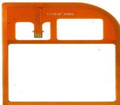
RF 射频天线系列包含 RFID 射频天线、GPRS 射频天线等产品系列。射频天线对于线路蚀刻精度、线间的阻抗等要求比普通的 FPC 要高。公司自主开发整套 Roll to Roll 天线制造工艺，生产高精度的 RF 射频天线，满足物联网行业对 RF 射频天线的产品要求，产品主要应用手机天线、工业手持机射频天线、金融 POS 机射频天线等。
