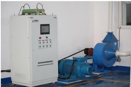
公司首创的基于双绕线转子结构的无刷双馈电动机产品优势：系统成本低，只用 30%的电机容量的低压变频调速装置，能够驱动高压电机；系统效率高达 96%；低速时输出高达 1.67 倍的额定转矩，适合低速重载场合应用；无刷结构，系统可靠性高。
