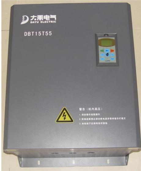
的三相电机的运行，可起到调速节能的作用。高精度无速度传感器闭环矢量控制技术，具有良好的转矩动态响应能力，适应重载场合应用；多脉冲整流技术，在大功率应用场合，可以降低谐波的同时提高电网稳定性和改善电网质量；公共直流母线技术，在冶金、钢铁、纺织、造纸等行业中需要多台电机同时运转的场合，回收利用了再生能量，大量降低了能耗；多台变频器自由并联技术，满足了超大功率容量的需求；高性能重叠旁路技术，可随时无冲击地将输出与电网同步切换；控制精度高，速度控制精度可达 0.05%，调速范围 1: 100，转矩响应小于 150ms，转矩控制精度±1%，起动转矩在 0.1Hz 120%额定转矩。
