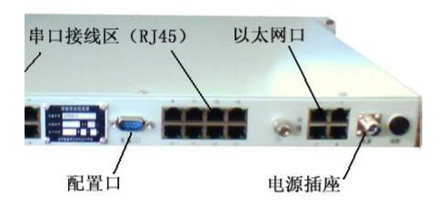
②通信矩阵交换器是公司生产的物理交换设备,型号为 KJ0702-II,针对数据信息的分路功能进行设计,采用上架结构以及 4U 标准机箱,能够实现输入信息的分路和多路信息的透明输出。
