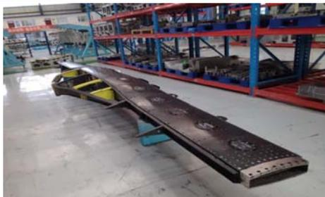
无人机复合材料中央翼部段
