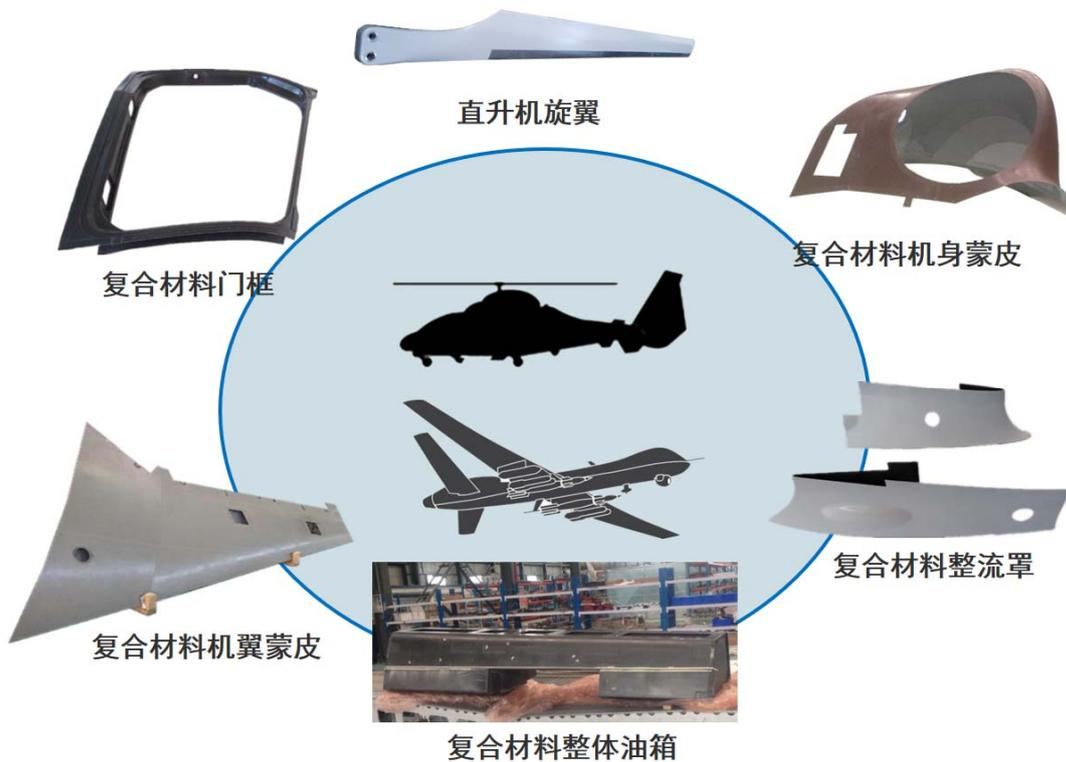
公司还会根据下游客户需求，将自行生产的航空零件组装成航空部段后销售，体现了公司较高的集成化水平。公司航空部件的主要产品包括某型无人直升机尾部机身部段、无人机尾部机身、无人机复合材料中央翼部段、某大型隐身飞机机翼部段等。
