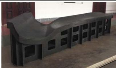
飞机整流罩成型工装
