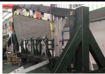
飞机机翼装配工装
