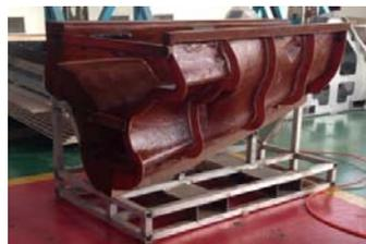
飞机整流罩成型工装
