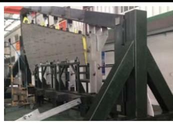
飞机机翼装配工装
