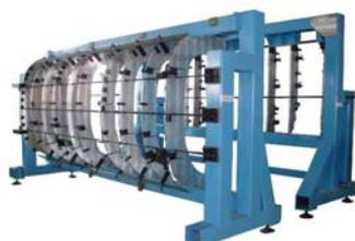
飞机机身壁板装配型架
