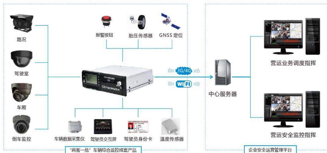
该系统主要实现了车辆位置、视频图像、报警信息、车辆运动姿态、车辆故障、动力系统状态、能耗趋势统计的综合监管及车辆调度等功能。
