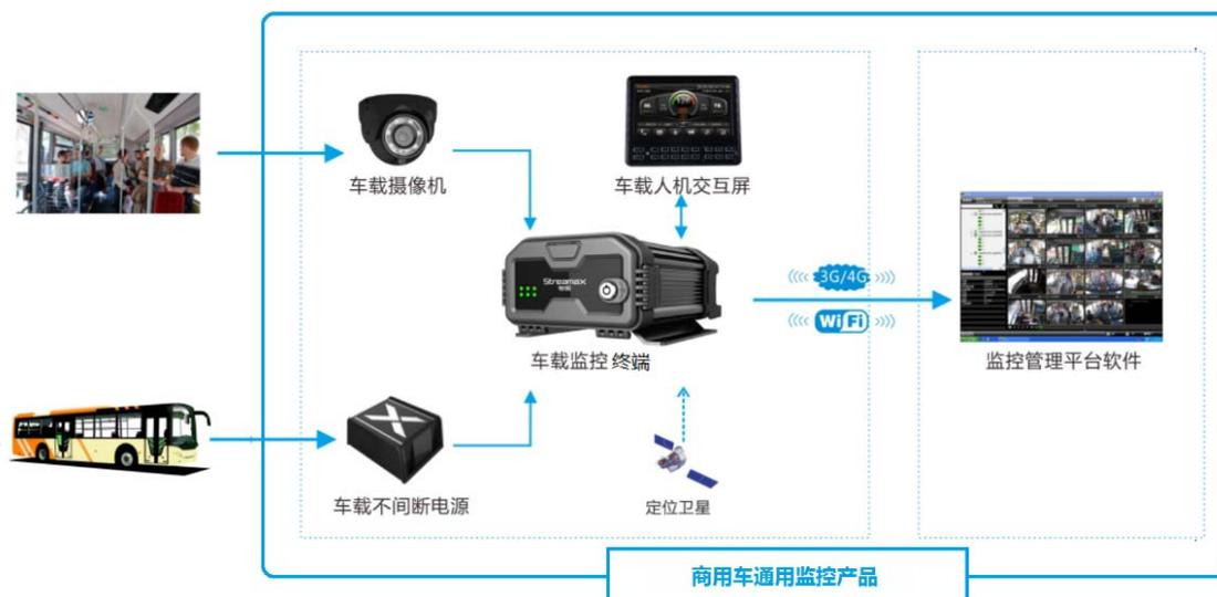
公司生产的商用车通用监控产品系统主要包括车载监控终端、车载摄像机、车载不间断电源等各类选配的专业车载外设及监控管理平台软件。具体介绍如下：
