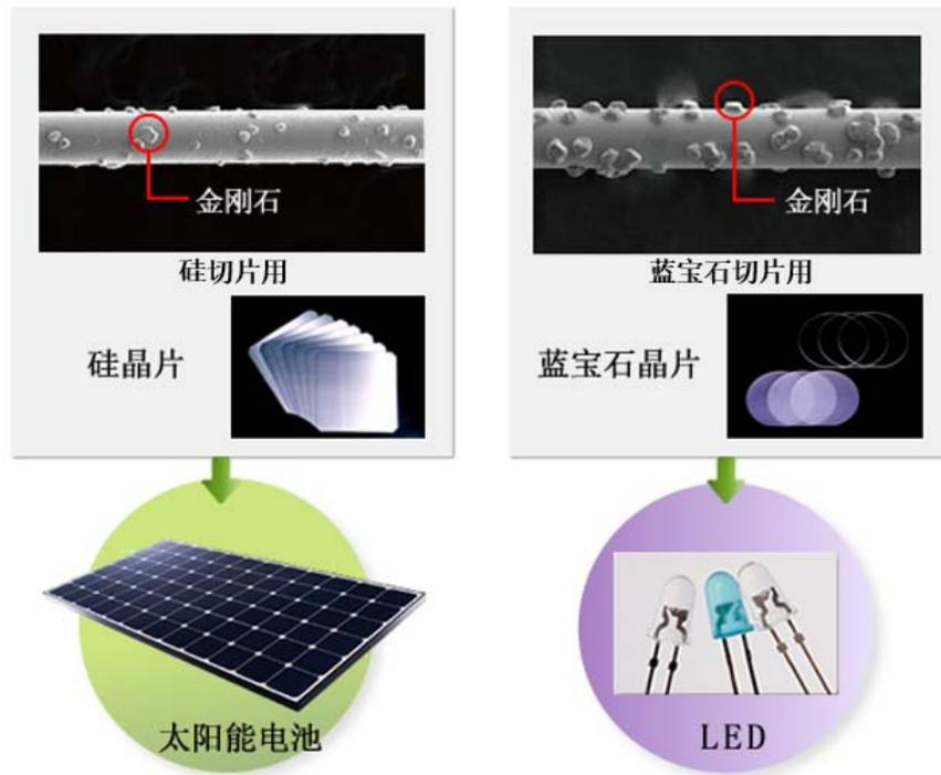
报告期内，公司的电镀金刚石线主要应用于光伏晶硅、水晶、磁性材料、蓝宝石等硬脆材料的切割，公司的电镀金刚石线主要产品按线径划分具体规格如下：
