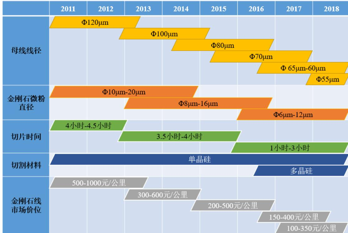
金刚线在切割多晶硅片时，由于硅片表面损伤层减少，不利于使用传统腐蚀方案对硅片进行绒面制备，进而影响多晶硅片的转化率；2017年，黑硅及添加剂等新技术的出现解决了金刚线切割多晶硅片反射率过高的问题，使得硅片光吸收能力提升。由于单晶硅片率先完成了金刚线切割工艺转换，硅片成本大幅降低，单晶硅片的市场份额迅速提高，在此背景下，金刚线在多晶切割领域的渗透速度大幅加快，截至2017年，以保利协鑫、晶科能源等为代表的多晶龙头企业均开始大规模使用金刚线切割工艺。因此，金刚线市场需求在2017年-2018年期间连续大幅增长。
