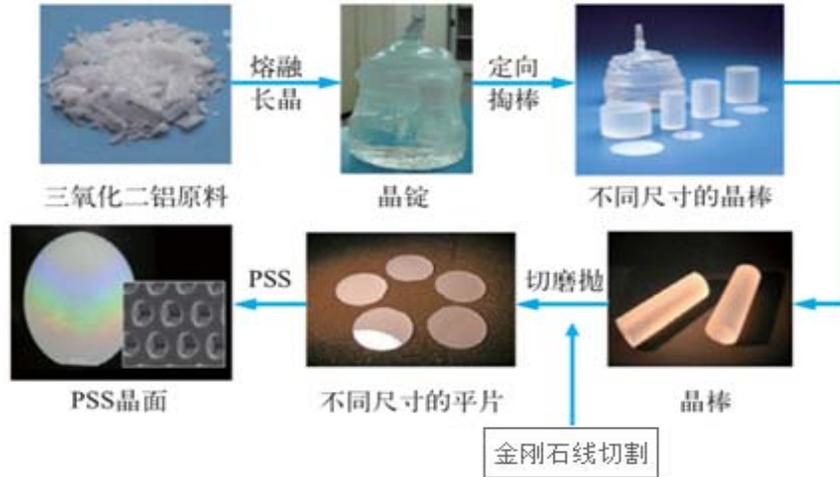
蓝宝石作为LED衬底材料的主要生产流程为：由蓝宝石坯料（主要为高纯度的 $\text{Al}_2\text{O}_3$ ，一般纯度要求99.996%以上）经过熔融长晶成蓝宝石晶锭，再通过定向、掏棒等工序加工成蓝宝石晶棒，晶棒经切片、研磨、抛光、清洗等工序制成蓝宝石基片，对于采用了图形化衬底（PSS）技术的衬底，还需在蓝宝石基片的基础上进行PSS工艺。其中，金刚石线主要应用于晶棒的切片环节，其切割质量直接影响蓝宝石基片及LED产品的质量及性能。
