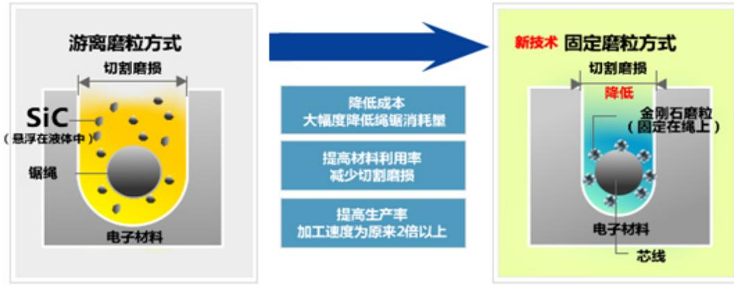
金刚石线切割工艺相较上一代游离磨料砂浆切割工艺具有巨大优势，主要体现在：1）大幅降低线耗成本；2）提高材料利用率，大幅降低切割磨损；3）提高切割速度，大幅提升切片效率；4）摒弃游离磨料砂浆切割所使用的昂贵且不环保的碳化硅等砂浆材料。因此，最近几年金刚石线快速取代游离磨料砂浆线成为光伏行业晶硅切片的主流切割工艺。
