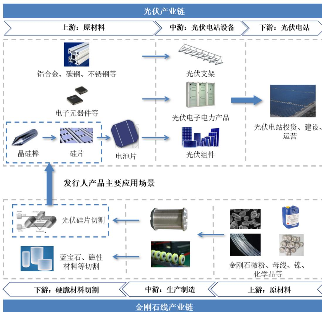
从晶体硅切割技术的发展历程来看，硅片切割方法经历了内圆锯切割、游离磨料砂浆切割、金刚石线切割的技术升级路线，其中每一步改进都带来了原材料利用率、切割效率的提升和硅片单位切割成本的降低。目前，主要的单、多晶硅片生产厂商已全面采用金刚石线切割工艺。
