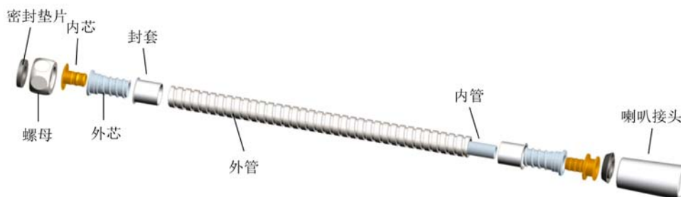
图4 软管结构图
