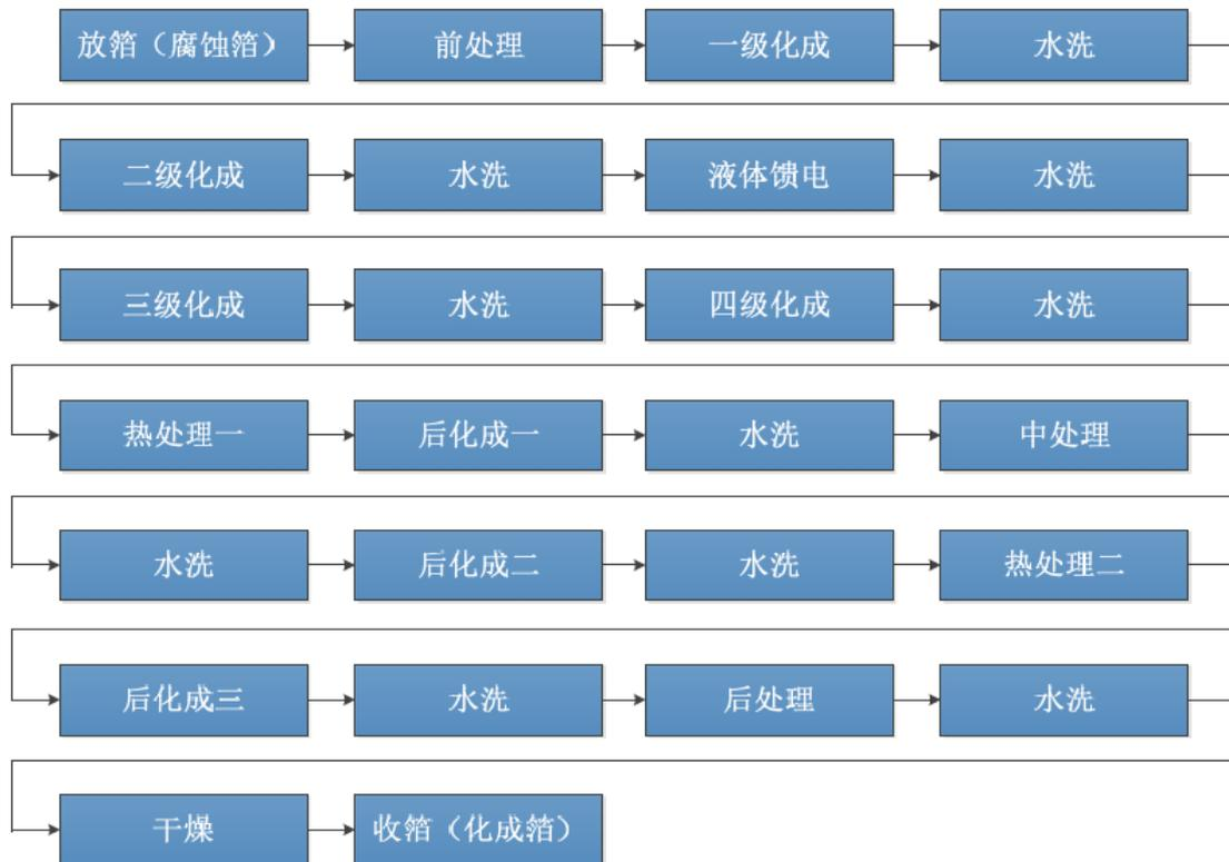
（1）前处理：在高温去离子水中，对腐蚀箔进行水合处理，使腐蚀箔表面生成水合氧化膜，减少后续化成工序的耗电量；
