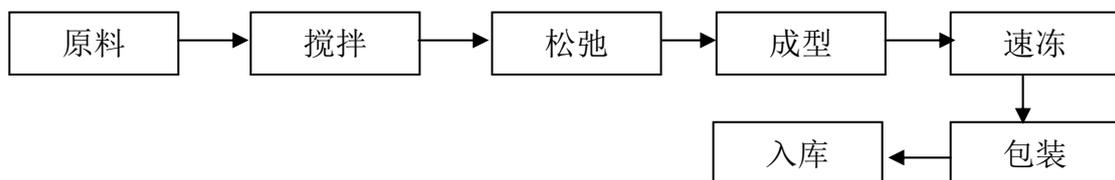
该工艺将面粉、油脂等原料经由称料、搅拌、分割、杆压、松弛、成型等步骤后，在-35℃之下急速冷冻，最终形成属于面包的冷冻半成品。该工艺使用合适的面团配方、冷冻专用面粉及酵母，结合公司为冷冻面团开发的低熔点油脂，严格管控操作温度与时间，以保证面团风味、体积、挺立性与口感。公司冷冻面
