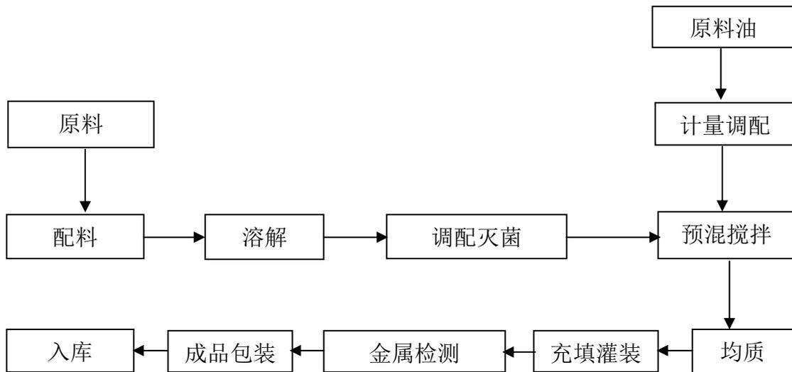
该工艺使用油脂及淀粉等作为主要原料，添加天然素材，食品添加剂、食品用香精等材料，通过预混合及制备（如加热、打发）等工艺，制成用于面包西点蛋糕表面或夹心馅使用的馅料。该工艺主要应用于焙可芯和焙可诗等烘焙食品馅料和即食馅料品牌产品。
