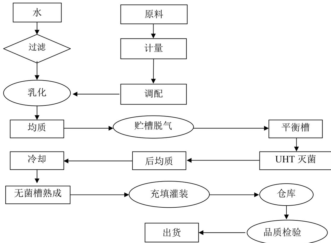
该工艺主要使用精炼植物油、天然奶油、全脂奶粉、脱脂奶粉等作为原材料，通过调配、乳化、均质，再通过 UHT 超高温灭菌系统杀菌、后均质、冷却和熟成等工艺，令产品达到无菌标准的同时，最大限度的保留原有自然风味、营养成分，使产品具有较长的保质期。该工艺制成的淡奶油产品广泛应用于制作甜点、慕斯、蛋糕和蛋挞等各种烘焙品。
