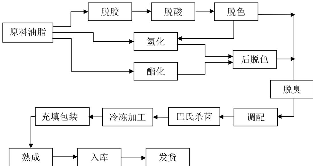
该生产工艺流程包括脱胶、脱酸、脱色、酯化、脱臭、调配、巴氏杀菌、冷冻加工、熟成等工序，将原料油进行提炼、过滤，再根据需要对原料油进行油脂改性以改变其原有特性，使其应用在烘焙面包、蛋糕等烘焙类产品时产生不同的效果。该生产工艺主要应用于人造奶油、起酥油等烘焙应用油脂。
