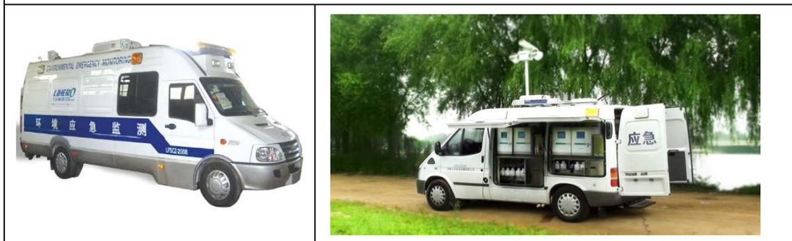
以水质在线分析仪为基础，经小型化和模块化设计，可以作为便携式设备单独使用，也可以作为水质分析仪器模块集成于车载应急监测系统之中。
