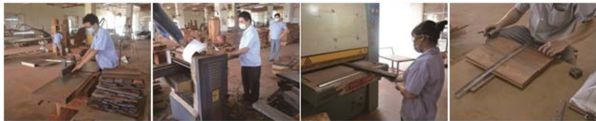
平刨 → 压刨 → 骨料砂光 → 拼板
