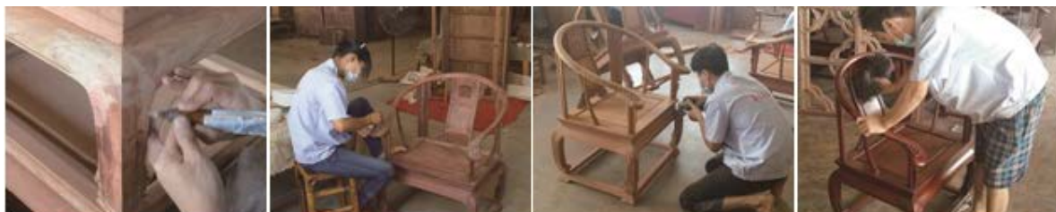
接线 → 整体刮磨 → 整体磨光 → 涂饰
