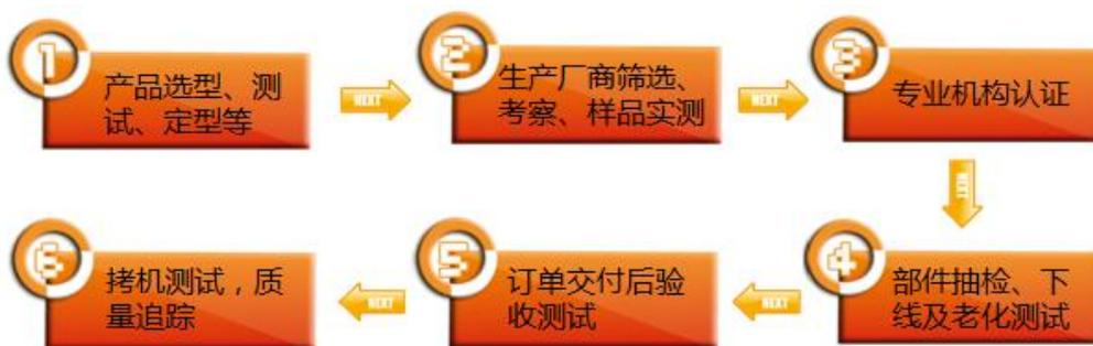
1、产品选型、定型：硬件设备每个部件的选型、定型须筛选国内三家部件供应商，并提供样品内部测试及厂家联合测试。同时对部件供应商进行市场调查，调查内容包括市场占有率、行业应用、品质保障流程等。
