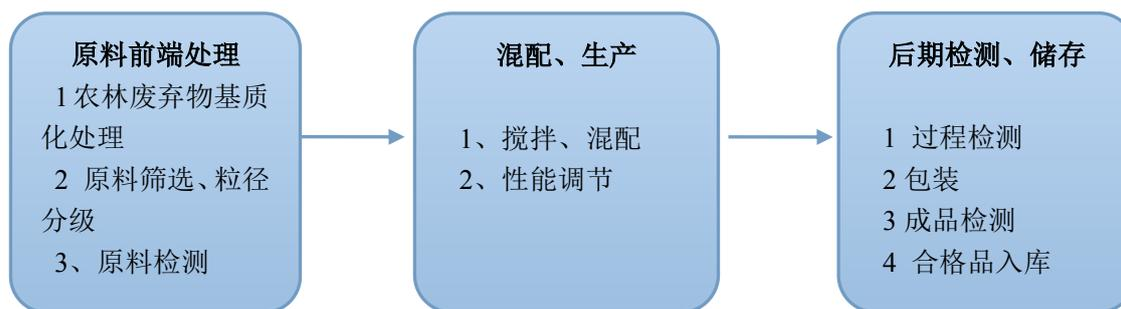
生物基质生产工艺流程主要包括：原料前处理，原料混配，调节酸碱度/湿度，包装，入库等。
