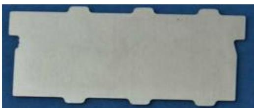
图2-4. CT探测器钨合金反散射隔栅片
