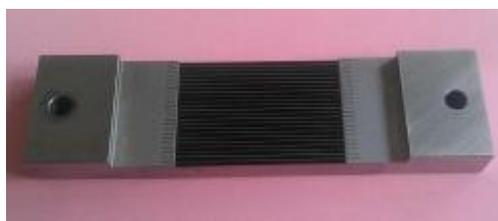
图2-5. CT探测器钨合金反散射模块
