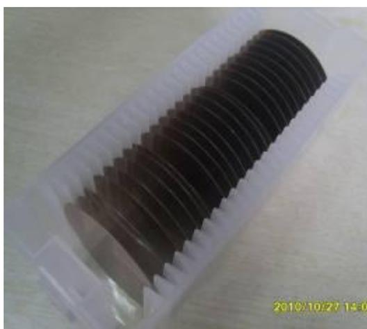
图2-18. LED用2吋钨铜合金基板
