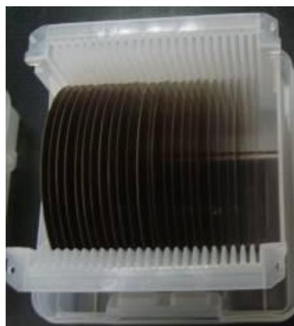
图2-19. LED用4吋钨铜合金基板
