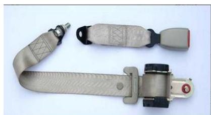
**产品介绍：**是一种用锦纶、维纶、蚕丝料制成的带状物品，加上卡轮，卷收器及其它附件，通过两点，三点，甚至多点 and 车身连接，在车辆发生各种事故时，固定乘客以及驾驶员的一套装置。
