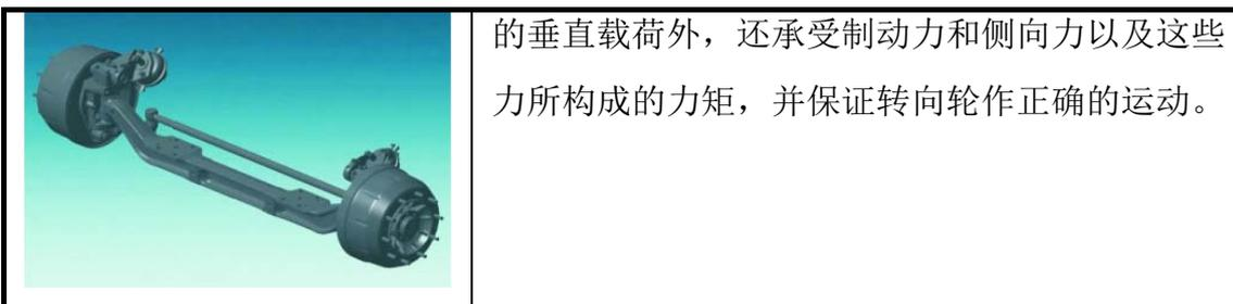
的垂直载荷外，还承受制动力和侧向力以及这些力所构成的力矩，并保证转向轮作正确的运动。
