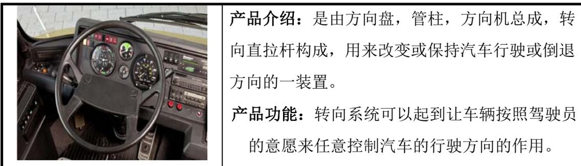
**产品介绍：**是由方向盘，管柱，方向机总成，转向直拉杆构成，用来改变或保持汽车行驶或倒退方向的一装置。
