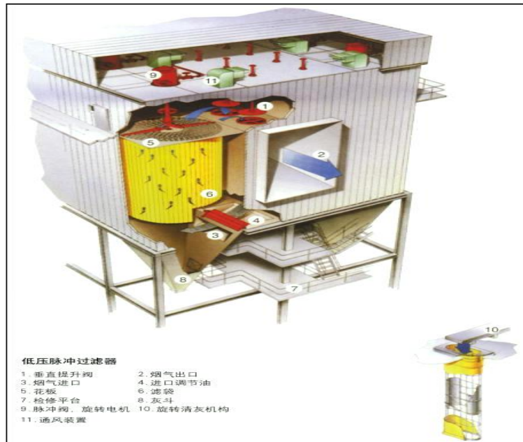
图5 旋转喷吹脉冲袋式除尘技术系统原理图
