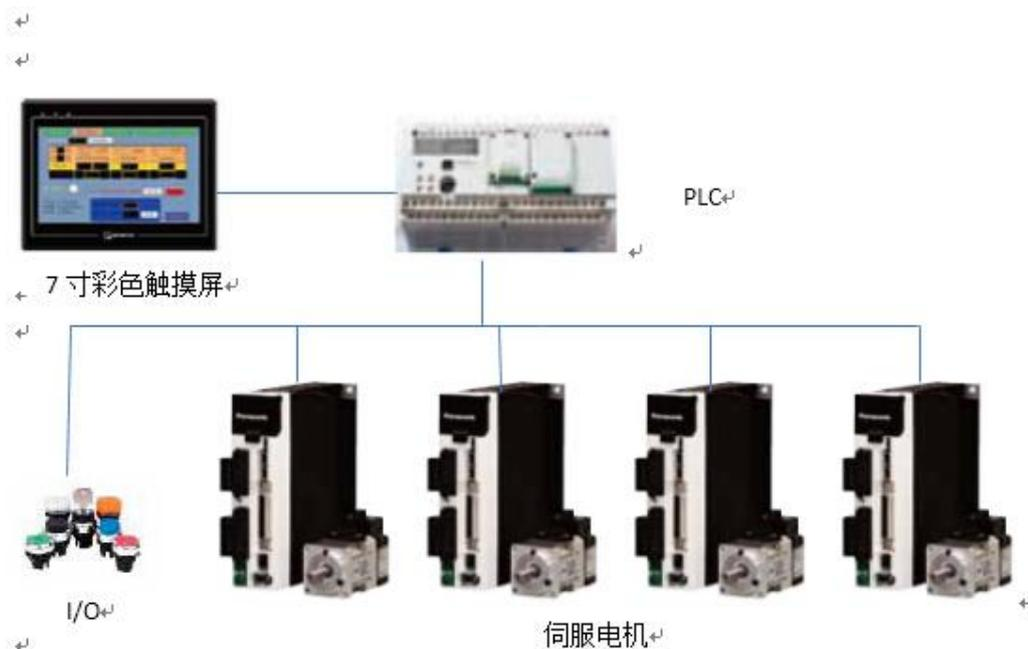
(6) RTEX 网络伺服控制系统结构图
