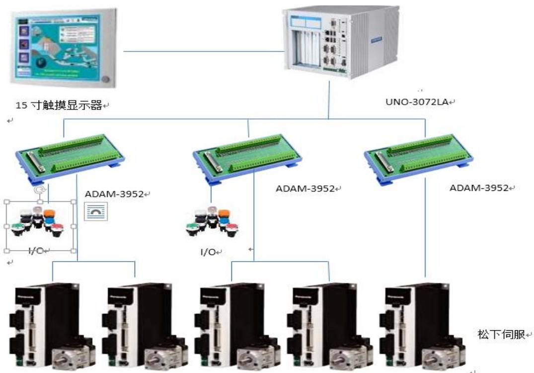
(5) 高速织带机控制系统结构图
