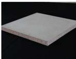
PFC 耐火保温板 (Phenolic Foam Composite) 是公司自主研发、拥有发明专利权的新型复合材料, 主要应用于建筑围护体系的屋面和墙体的隔热保温, 也可作为隔热保温芯材用于工业化生产保温装饰一体板、大跨度建筑的轻质屋面。该产品在质量轻、韧性强、强度高的特点基础上, 具有“三低四好”的突出优点 (形变量低、导热系数低、吸水率低, 绝热性好、透气性好、施工性好、经济性好), 解决了火灾条件下材料自燃、火点扩散、火势蔓延、材料结构丢失的技术难题, 燃烧等级和耐火性能超越了传统有机保温材料, 已达到 GB8624—2006《建筑材料及制品燃烧性能分级》B 级, 符合保温材料“五性合一”的技术研发要求, 同时满足了建筑保温与建筑消防对保温材料的性能要求。
