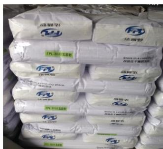
FPL 乳胶粉是建筑外墙保温系统中起强固粘接作用及增加柔韧性的添加物。公司 FPL 乳胶粉主要包括以下两类产品：
