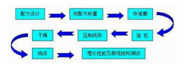
氮化硅陶瓷工艺流程简述: 硅粉、添加剂混合均匀后经过造粒机造粒,通过 氮气在保温炉反应,一段时间经修整合格品包装。
