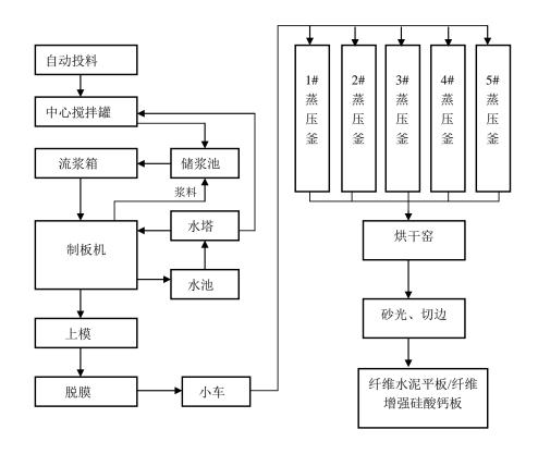
硅酸钙板产品采用无石棉配方生产,其中部分原料是从社会上回收的各种废纸,实现了资源综合利用。制板方式采用流浆法,生产线主机设备产量可达 5 至 6 张/分钟。在料浆制备环节上,采用电脑控制配方,原料配料、料浆浓度自动化控制,生产线机械化程度高,保证了产品的质量和产量。以下为硅酸钙板产品主要生产工艺的描述:
