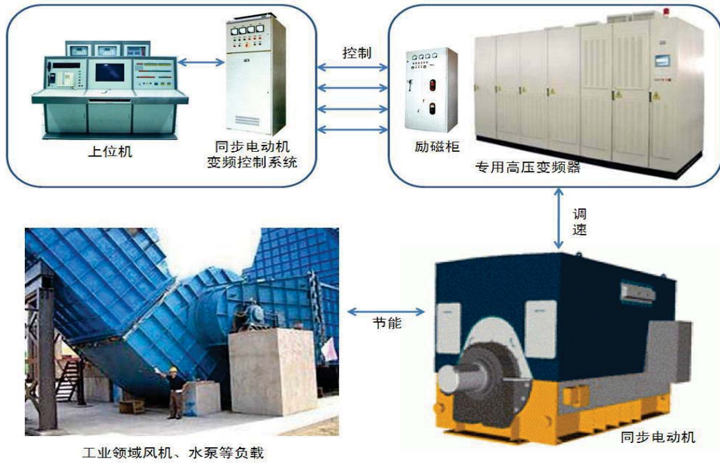
图：大功率高压同步电动机变频调速系统工作流程图
