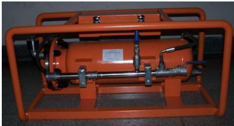
图 1 管道自动加液混合装置
